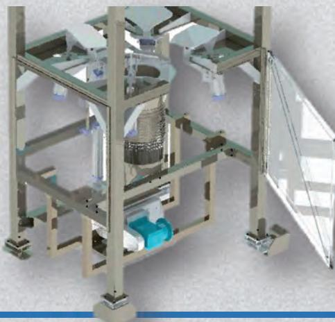
**Dosatore volumetrico con agitatore e tramoggia di carico**
